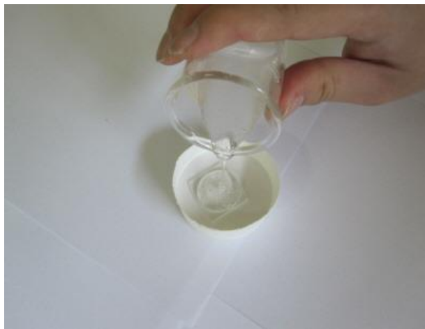
그림 12. Pour PDMS into the mold.
